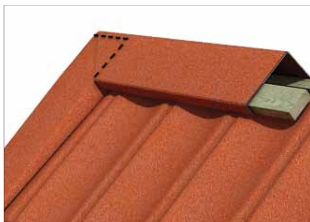
LIGE RYGNING OG FORTANDET GAVLAFSLUTNING
