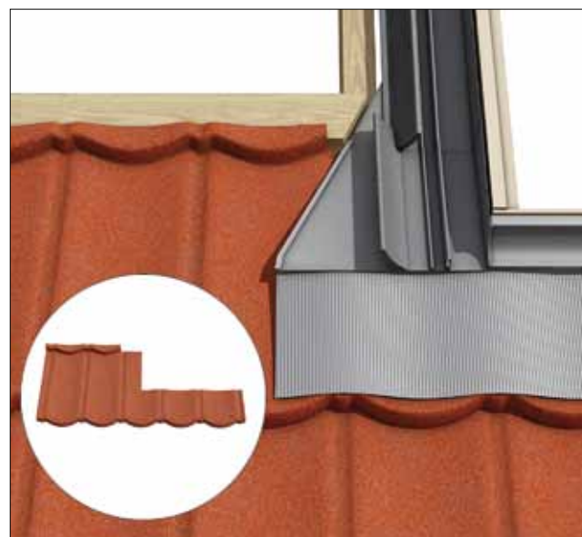
Principskitse for skæring af Decra plader ved underkarm.
